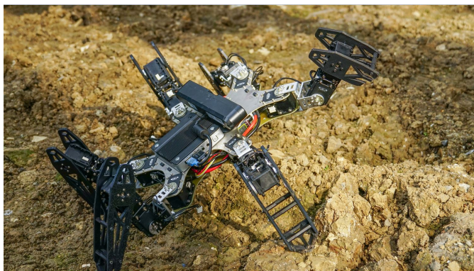
FIGURE 1. Notre robot hexapode apprend de manière autonome comment faire face à des situations de pannes mécaniques grâce à notre algorithme « Intelligent Trial & Error ». La photo montre le cas où l'une des pattes du robot est cassée. Pour continuer à avancer malgré la panne, le robot utilise une carte contenant différentes façons de marcher et leur performance respective qui a été générée a priori à l'aide d'une simulation physique. Pour s'adapter, le robot sélectionne un comportement qu'il prédit comme étant efficace et le teste en réalité. Si le comportement sélectionné ne fonctionne pas, le robot continue son exploration de la carte en sélectionnant un nouveau comportement qui est à la fois suffisamment différent du précédent et prédit comme étant performant. Ce nouvel algorithme permet à des robots endommagés de continuer leur mission après seulement une minute de temps d'apprentissage et moins d'une dizaine d'essais.
