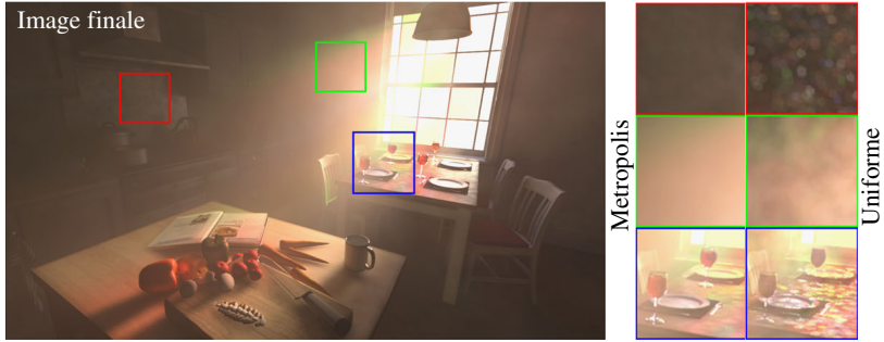
FIGURE 5. Scène Vitraux : éclairage à travers les fenêtres subissant une absorption et une diffusion par la poussière. Pour cette scène, l’algorithme de Metropolis a été utilisé. En effet, il est difficile de trouver les chemins lumineux passant par la fenêtre. Par ailleurs, nous montrons des zooms pour comparer la technique avec et sans (appelée uniforme) Metropolis. On observe une nette amélioration due à l’exploration locale faite par Metropolis.
